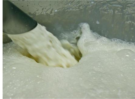
Una vez en el obrador, la leche pasa por un calentador de placas para aumentar su temperatura hasta los 29-31°C, y después directamente a las cubas para su cuajado mediante la adición de los fermentos lácticos y el cuajo natural.
