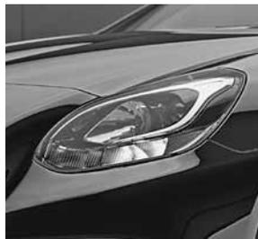
Faros principales en técnica de proyección H7 con luces diurnas integradas
